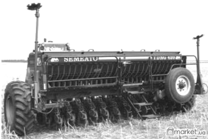
Рис. 3.3.3. Сівалка Semeato TDNG –420 для суцільного висіву. Відмінна якість посіву по будь-яким рослинним решткам
