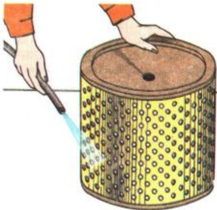
Рис. 7.29. Продувка основного фільтра-патрона повітроочисника стиснутим повітрям
